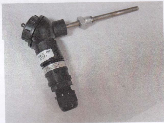
Рисунок 2 - Преобразователь в сборе с термопреобразователем сопротивления
